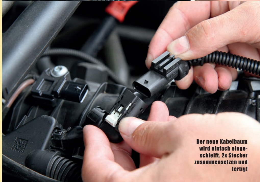
Auch der Ladedrucksensor ist leicht erreichbar. Die fummelige Verriegelung ist typisch.
